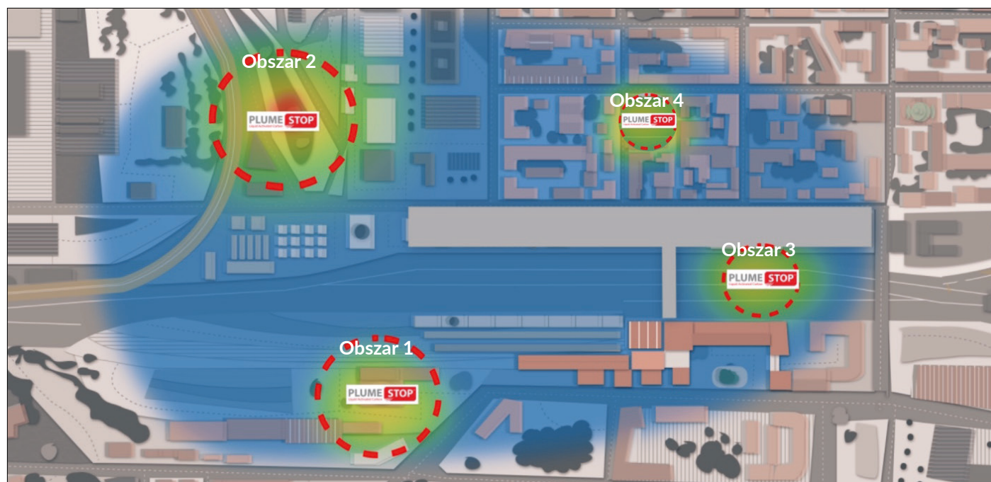
Rys. 7. Lokalizacja punktów objętych działaniem w ramach projektu na pełną skalę techniczną: ukierunkowanie na 4 “gorące punkty” w obrębie szeroko rozprzestrzenionej smugi rozpuszczalnika chlorowanego o niskim stężeniu.
